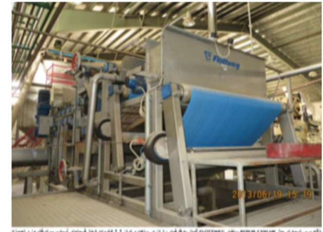
خانه روس شده از سال ۱۳۸۵ ساخت FLOTTWEG مدل به ظرفیت ۱۰ تن در ساعت و توان ۹۰ کیلووات شامل سیستمهای آسیاب، سردخانه و تجهیزات
